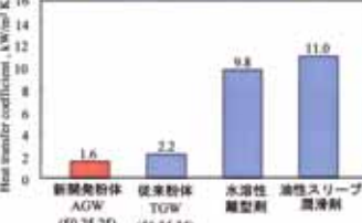
Fig. 新開発AGW型・高断熱性スリープ潤滑粉体と他の離型潤滑剤の断熱特性比較
